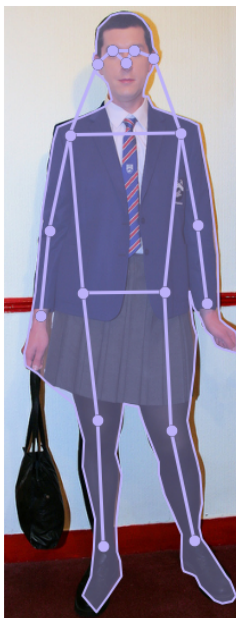
Obrázek 2.1: Kostra člověka složená ze 17 klíčových bodů podle formátu COCO. Obrázek 000000042102.jpg převzat z [8].
